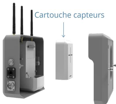
Maintenance et calibration optimisées: remplacement annuel de la cartouche capteurs.
